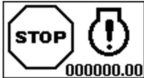
Generiskt motorfel – stopplampans status
