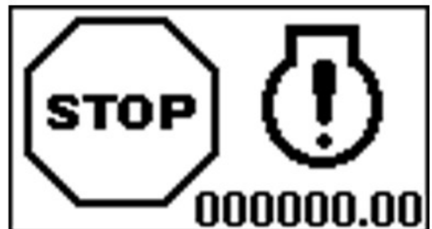
Algemene motorstoring - Status van stoplamp
