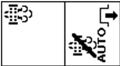
Reiniging vereist - Automatische regeneratie uitgeschakeld
