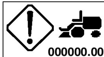
Algemene machinestoring - Status waarschuwingslamp
