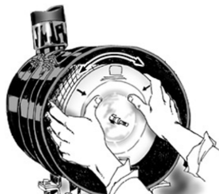
Крепление вкладыша фильтра
