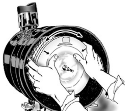
Τοποθέτηση του εξωτερικού στελέχους
