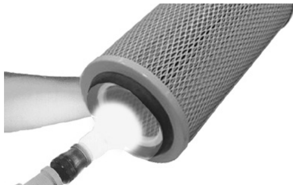
Contrôle de l'élément filtrant
