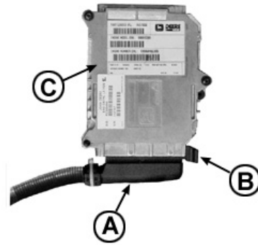
A—Connecteur B—Cliquet de blocage C—Contrôleur du moteur
