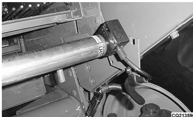
Монтаж датчика, справа
