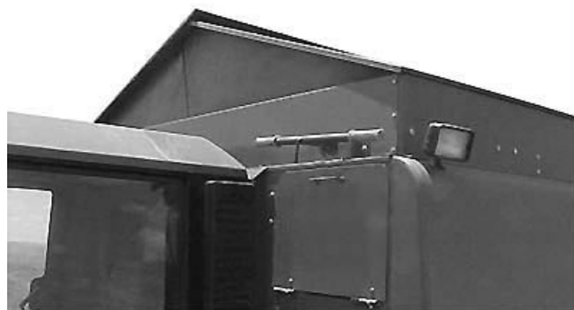
Надставка зернобункера - Положение ведения уборки
