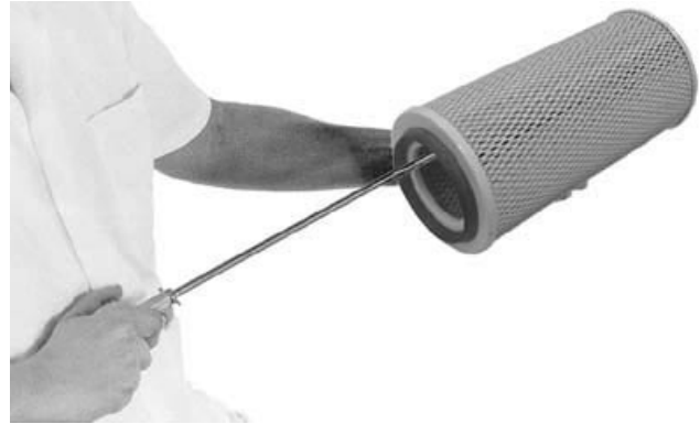
Очистка вкладыша фильтра
