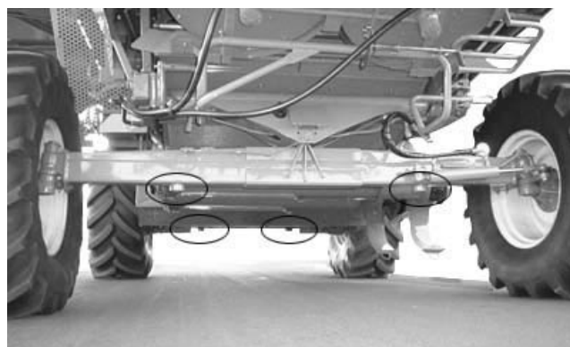
Точки поддомкрачивания на комбайне
