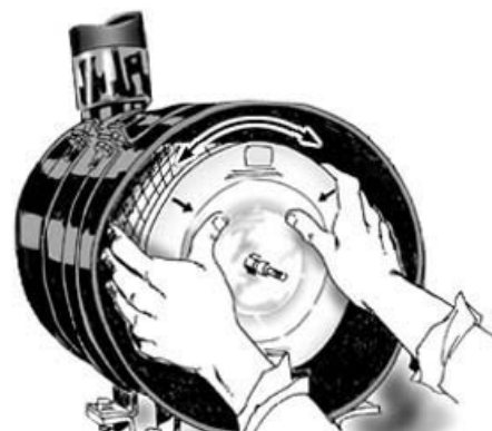
Установка вкладыша фильтра
