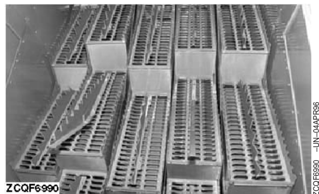
Рыбы плавники соломотрясов — Модель для уборки риса — 1450/1550
