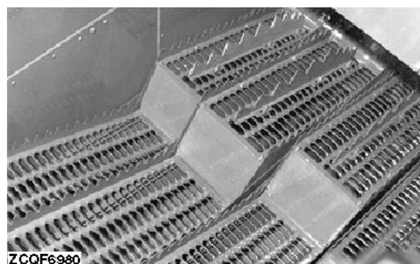
Levantadores dos saca-palhas—versão básica—1450/1550
