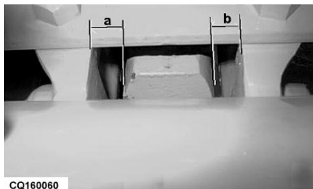
Ponto de verificação do alinhamento da esteira
