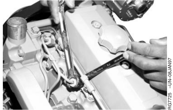
Linha de Pressão do Bico Injetor
