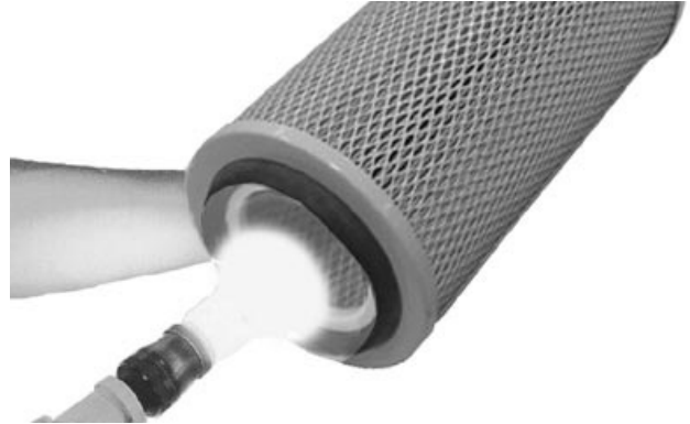
Inspeção do elemento filtrante
