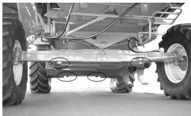
Pontos de apoio do macaco na colheitadeira
