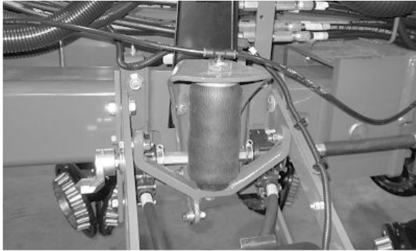
Ressort pneumatique correctement enroulé
