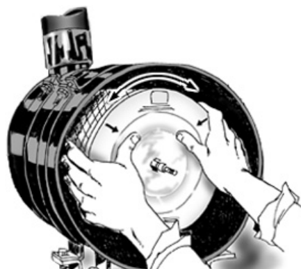
Montaje del filtro
