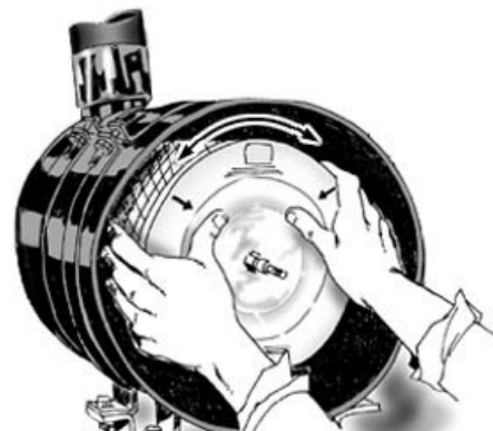
Postavljanje uložka filtera
