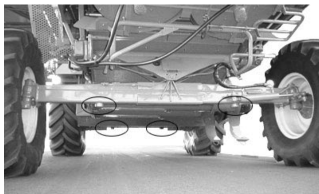
Tačke oslonca na kombajnu pri podizanju dizalicom
