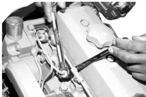
Tubería de presión en el inyector
