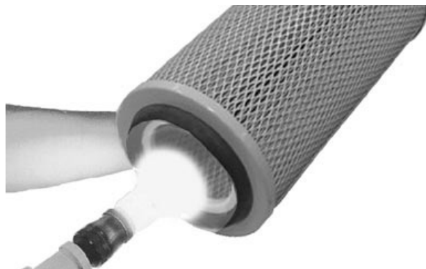
Comprobación del elemento filtrante
