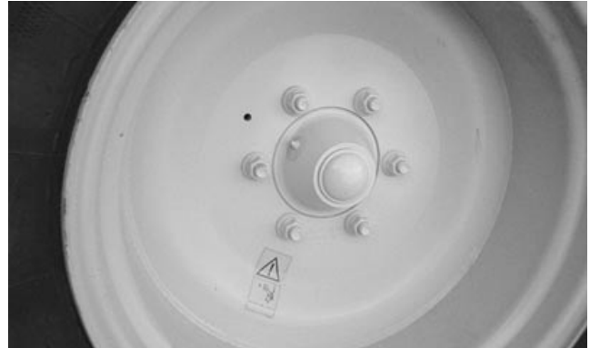
Rueda trasera (eje no motorizado)
