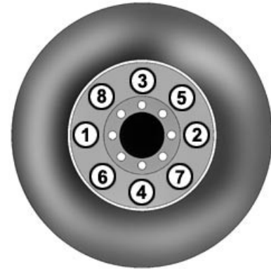
Secuencia de apriete de tornillos de la rueda para ejes motorizados
