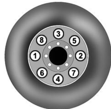
Secuencia de apretado de tornillos de la rueda para ejes motorizados
