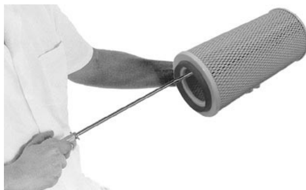
Limpieza del elemento filtrante
