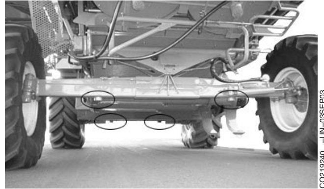
Puntos de enganche de la cosechadora
