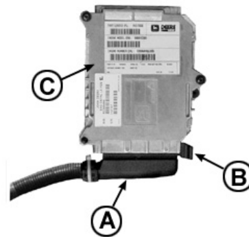
A—Steckverbinder B—Sperrklinke C—Motorsteuereinheit
