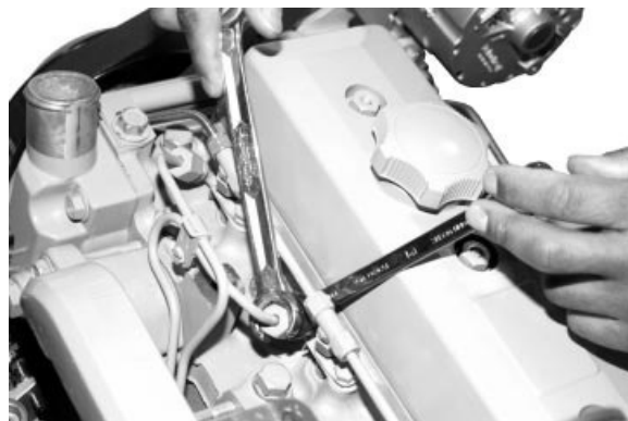
Tubería de presión en el inyector
