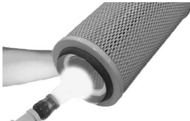
Ispezione della cartuccia filtrante
