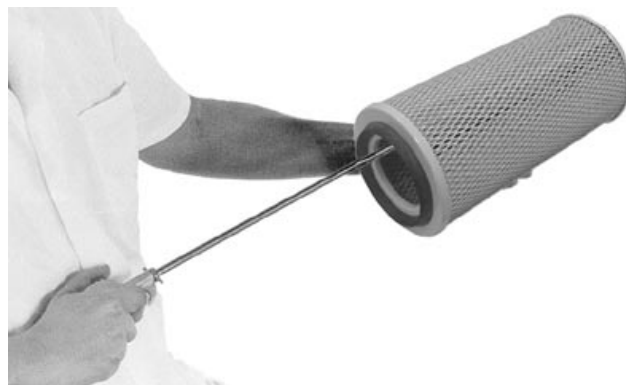
Limpeza do elemento filtrante
