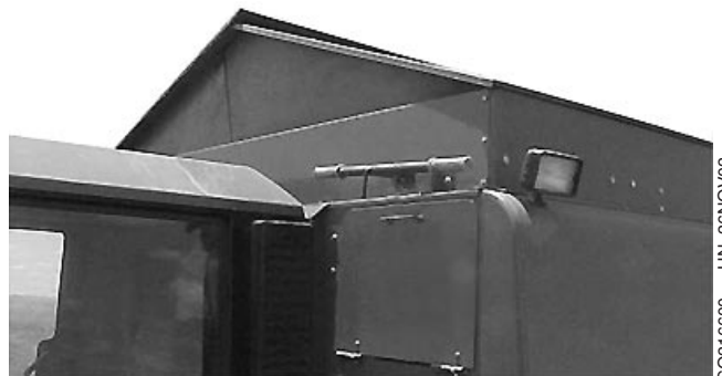
Extensão do tanque graneleiro na posição de trabalho
