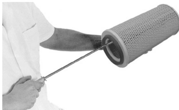
Rengöring av primärfilter
