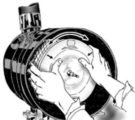
Hopmontering av luftrenare
