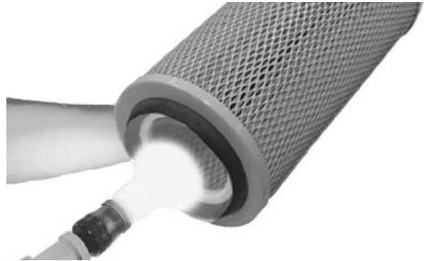
Contrôle de l'élément filtrant
