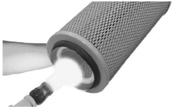
Inspección del inserto del filtro
