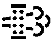
ICONCC058—UN—06JUN13 Automatinis suodžių filtro valymas įjungtas
