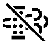
ICONCC059—UN—06JUN13 Automatinis suodžių filtro valymas neįjungtas
