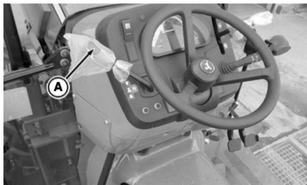
Reversinės pavaros svirtis (valdoma mechaniškai) (5GL ir 5GL-N)
