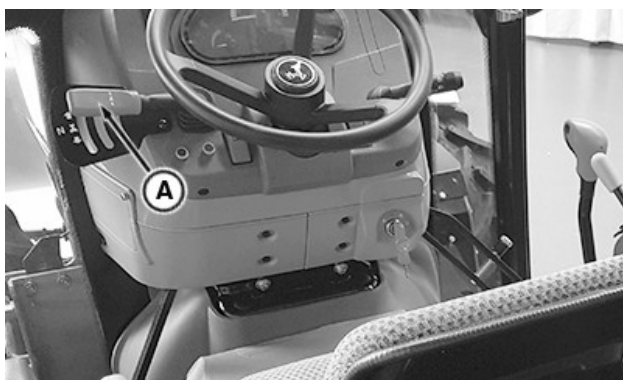
APY11177—UN—14MAY19 Reversinės pavaros svirtis (valdoma elektra) (5GL ir 5GL-N)
