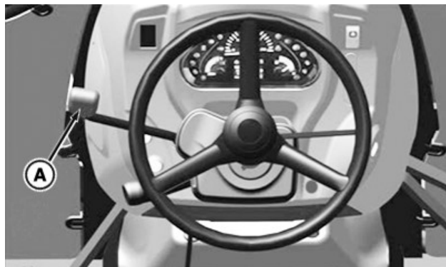
Reversinės pavaros svirtis (valdoma mechaniškai) (5GV, 5GN, 5GF)
