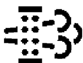
ICONCC058—UN—06JUN13 Pulizia automatica del filtro dei gas di scarico attivata
