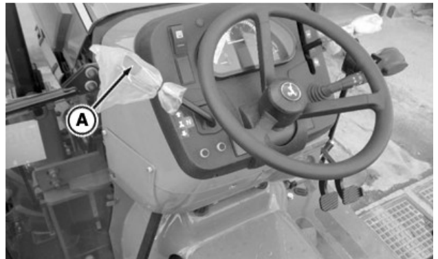
Fahrtrichtungshebel (mechanisch betätigt) (5GL und 5GL-N)
