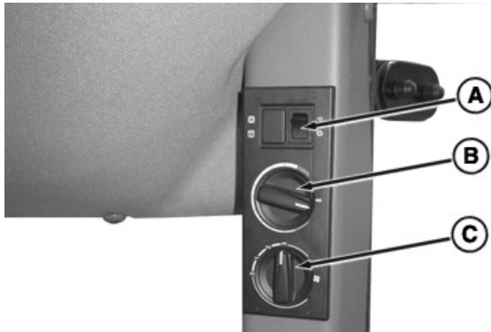
A—Klimaanlagenschalter B—Temperaturregler C—Lüfterdrehzahlregler
