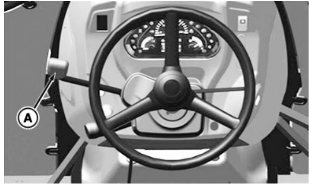
Fahrtrichtungshebel (mechanisch betätigt) (5GV, 5GN, 5GF)
