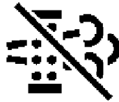
ICONCC059—UN—06JUN13 Automatische Abgasfilterreinigung nicht aktiviert
