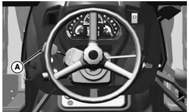
Fahrtrichtungshebel (elektrisch betätigt) (5GV, 5GN, 5GF)
