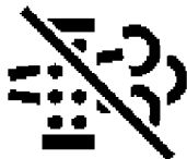
ICONCC059—UN—06JUN13 Nettoyage automatique du filtre à gaz d'échappement désactivé
