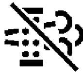
ICONCC059—UN—06JUN13 Pakokaasusuodattimen automaattinen puhdistus pois käytöstä
