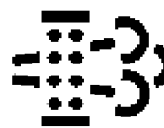
ICONCC058—UN—06JUN13 F1 - Automatic or Manual Regeneration Ongoing
