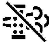
ICONCC059—UN—06JUN13 Automatische uitlaatfilterreiniging niet geactiveerd
