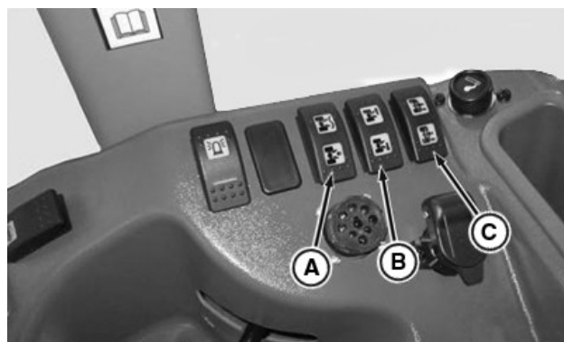
A—Prekidač poteznice — Namještanje plivajućeg položaja B—Prekidač poteznice — Pomicanje lijevo/desno C—Prekidač motki hidrauličnog cilindra — Izvlačenje/uvlačenje
