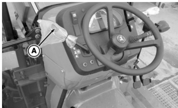
Ručica za promjenu smjera vožnje (mehanički pokretana) (5GL i 5GL-N)
