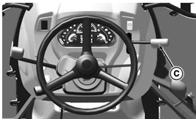
Лост за механични "бързи-бавни" предавки - (трактори 5GV, 5GN и 5GF)
