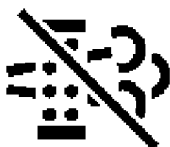
ICONCC059—UN—06JUN13 Avtomatsko čiščenje izpušnega filtra ni vključeno
