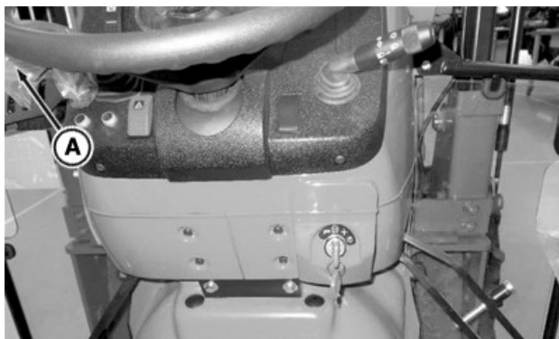
Maneta de marșarier (acționată electric) (5GL și 5GL-N)
