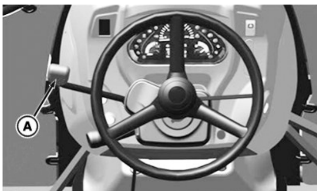
Maneta de marșarier (acționată mecanic) (5GV, 5GN, 5GF)
