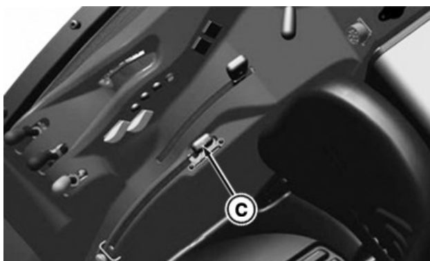
C—Maneta de control al cuplajului
