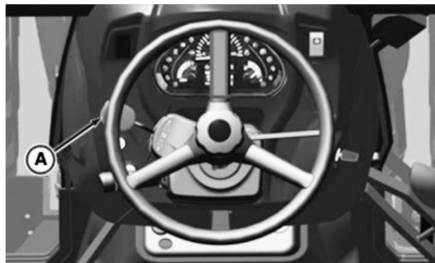
Maneta de marșarier (acționată electric) (5GV, 5GN, 5GF)
