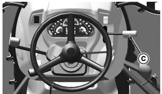
PY31877—UN—21SEP16 Alavanca de Mudança Alta-Baixa Mecânica - (5GV, 5GN, 5GF)
