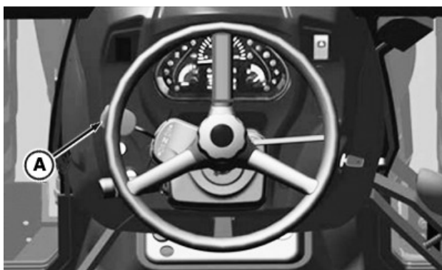
Alavanca de Sentido de Rodagem (Acionamento Elétrico) (5GV, 5GN, 5GF)
