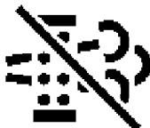
ICONCC059—UN—06JUN13 Limpeza automática do filtro de exaustão não ativada
