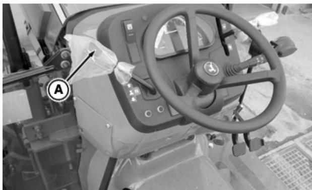
Alavanca de Sentido de Rodagem (Acionamento Mecânico) (5GL e 5GL-N)
