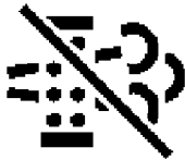
ICONCC059—UN—06JUN13 Automatyczne czyszczenie filtra spalin nie uaktywnione
