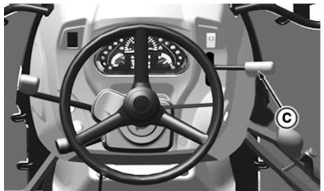
Mekanisk girspak for høygir/lavgir - (5GV, 5GN, 5GF)
