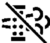
ICONCC059—UN—06JUN13 Izplūdes filtra automātiskā tīrīšana nav aktivizēta
