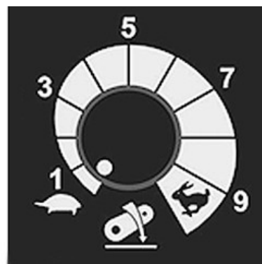
Bouton de commande de la vitesse de descente
