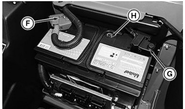
F—Câble positif de batterie
