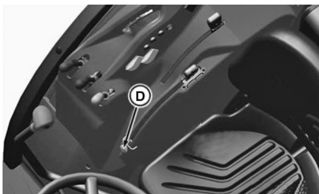
D—Écrou à créneaux
