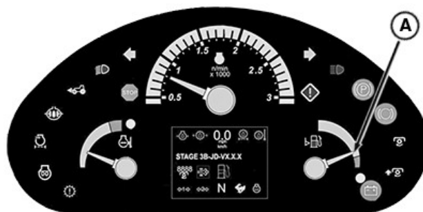
A—Jauge de niveau de carburant
