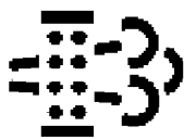
ICONCC058—UN—06JUN13 F1 - Régénération automatique ou manuelle en cours
