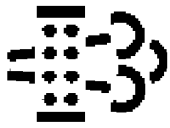
ICONCC058—UN—06JUN13 Pakokaasusuodattimen automaattinen puhdistus käytössä
