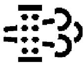
ICONCC058—UN—06JUN13 F1 - Automaattinen tai manuaalinen regeneraatio käynnissä
