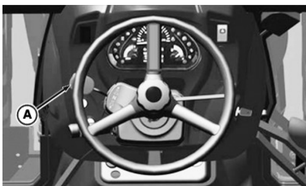
PY31894—UN—26AUG16 Rijrichtingshendel (elektrisch bediend) (5GV, 5GN, 5GF)
