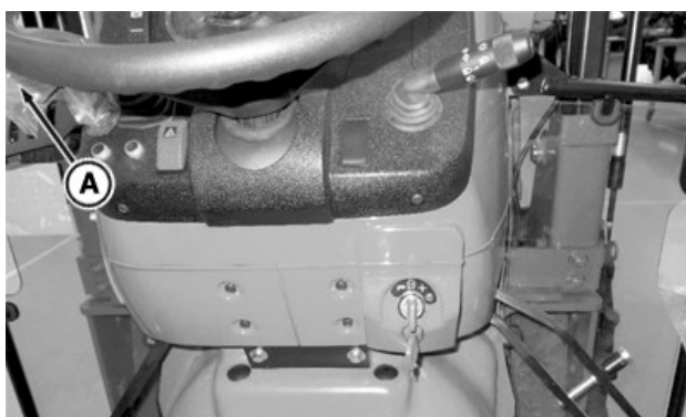
PY34660—UN—13JUL17 Rijrichtingshendel (elektrisch bediend) (5GL en 5GL-N)
