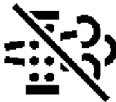
ICONCC059—UN—06JUN13 Automatische uitlaatreiniging niet geactiveerd
