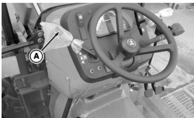
PY34659—UN—13JUL17 Rijrichtingshendel (mechanisch bediend) (5GL en 5GL-N)
