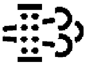
ICONCC058—UN—06JUN13 Automatische uitlaatreiniging geactiveerd
