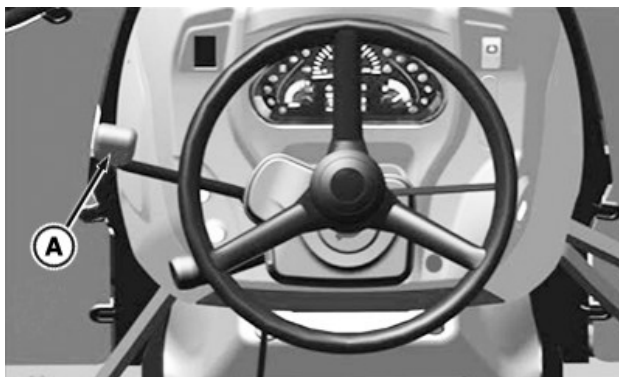
PY31893—UN—26AUG16 Rijrichtingshendel (mechanisch bediend) (5GV, 5GN, 5GF)
