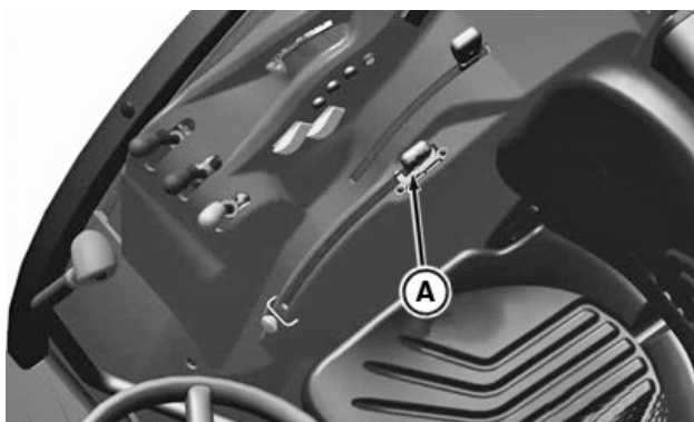
A—Betjeningshåndtag til positionsregulering
