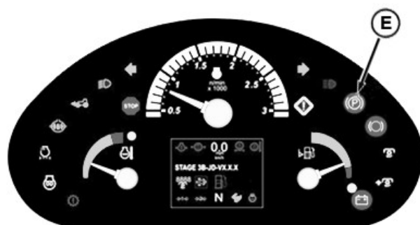
D—Ručica parkirne kočnice E—Kontrolna žaruljica parkirne kočnice
