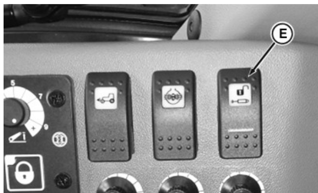
E—Prekidač transportne blokade
