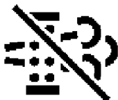
ICONCC059—UN—06JUN13 Automatsko čišćenje filtra ispuha nije aktivirano
