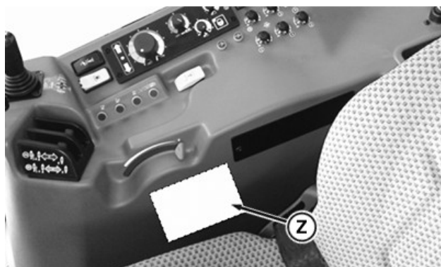
Z—E-SCV upravljačka jedinica (TCV)
