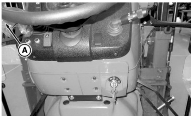
Ručica za promjenu smjera kretanja (električki pokretana) (5GL i 5GL-N)
