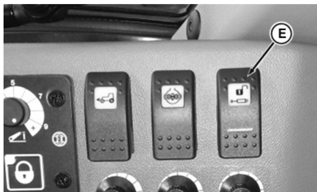
E—Prekidač transportne blokade
