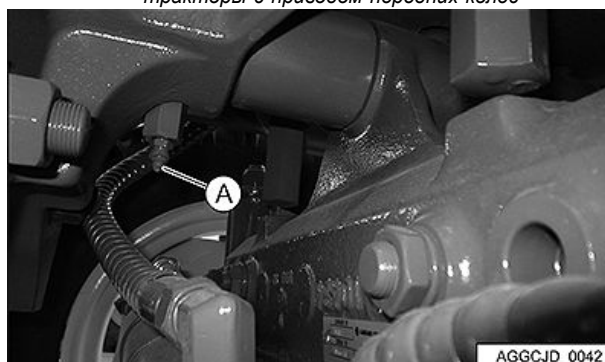
Смазочный фитинг шарнирного пальца — тракторы без привода передних колес
