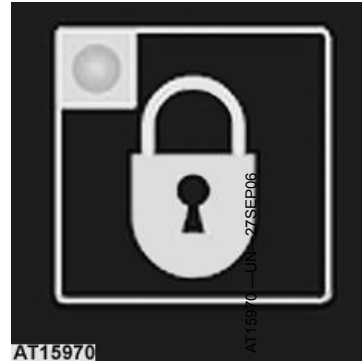
Переключатель транспортной блокировки (с красным светодиодом)
