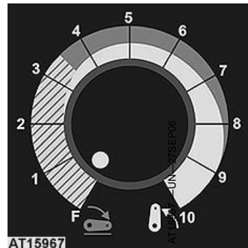
Переключатель регулировки заглубления
