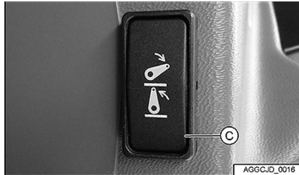
Органы дистанционного управления навеской, тракторы 5V, 5N и 5F (при наличии)
