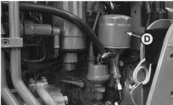
Двигатель F5C - Масляный фильтр
