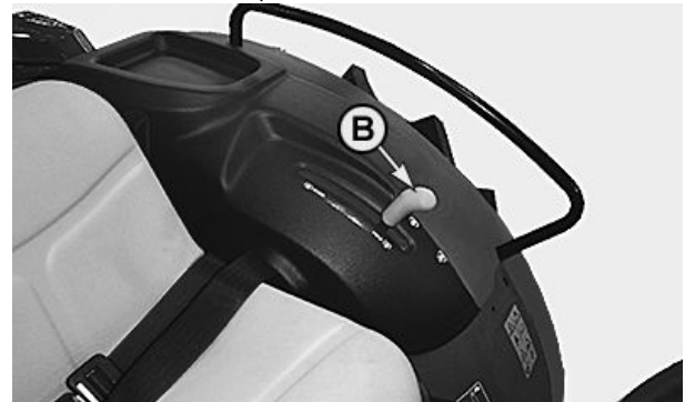
ВОМ в режиме работы с учетом ходовой скорости (электрогидравлическая версия)
