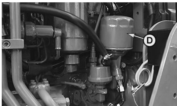
Двигатель F5C - Масляный фильтр
