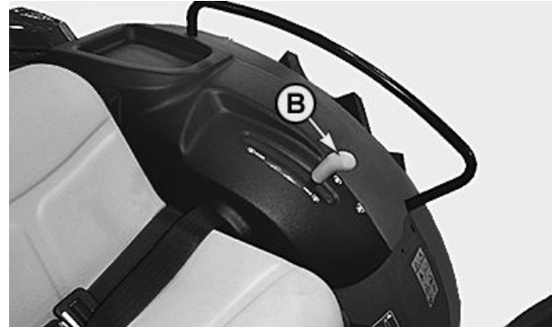
TDF sincronizada con el vehículo (versión electrohidráulica)
