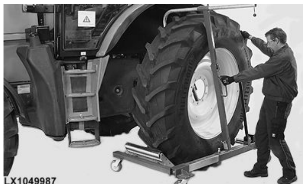
KJD10581—Количка за тркало JT02044—Статив за JT02043—Статив за поддршка, 863 до 1117 поддршка, 482 до 736 mm (34 до 44 in.) mm (19 до 29 in.)
