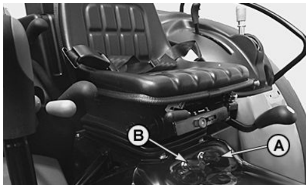
А—Вртливо копче за прилагодување на брзина-на-спуштање
