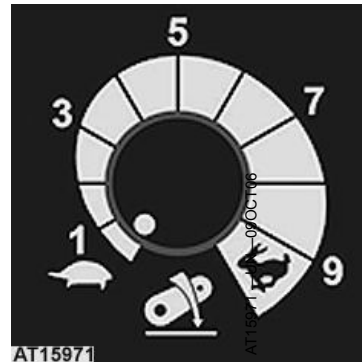
Διακόπτης ελέγχου ταχύτητας καθόδου
