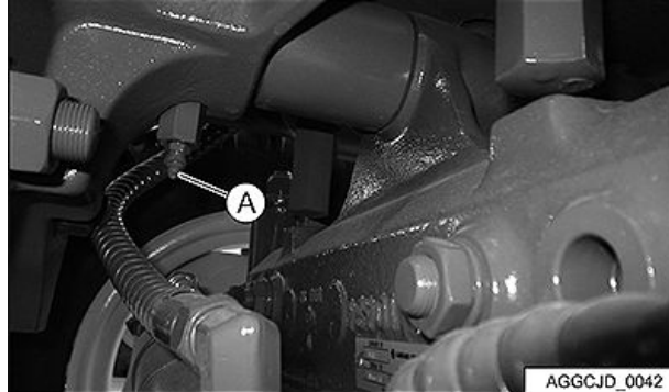
Mazalni nastavki za sornik tečaja — traktorji brez sprednjega pogona
