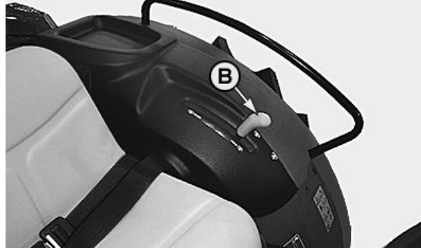
Priza de Putere cu Antrenare de la Sol (Versiunea Electro-Hidraulică)
