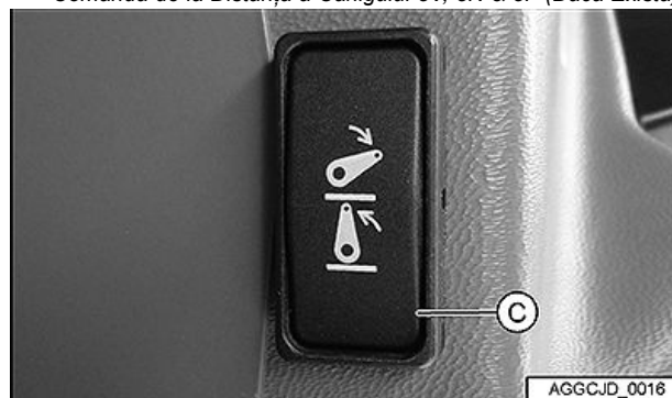
Comanda de la Distanță a Cârligului 5V, 5N & 5F (Dacă Există)
