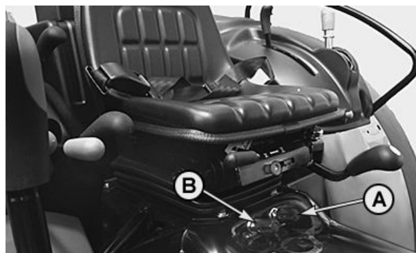
A—Justeringsknapp for senkehastighet
