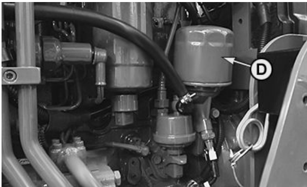
Motore F5C - Filtro dell'olio
