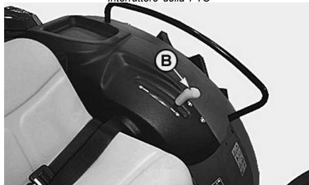
PTO azionata dalle ruote (Versione elettroidraulica)
