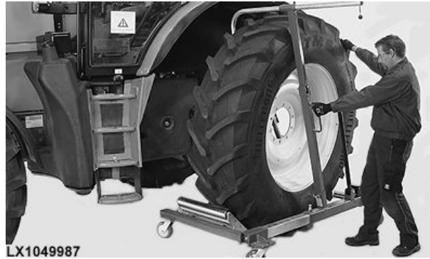
KJD10581—Carrello per ruote JT02043—Cavalletto di sostegno da 482 a 736 mm (19 a 29 in.)
