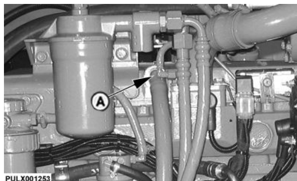
A—Tubo del respiradero del cárter
