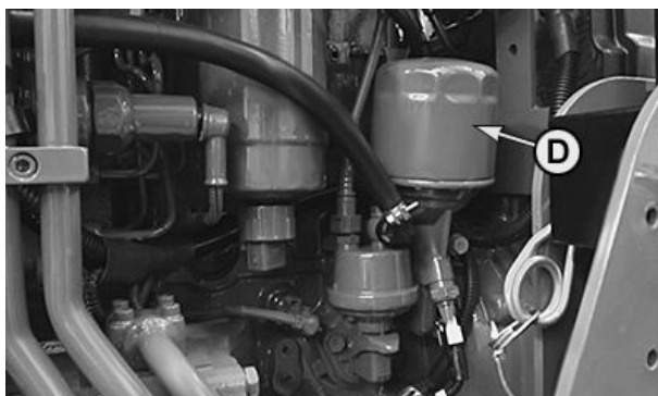
F5C motor - Oliefilter
