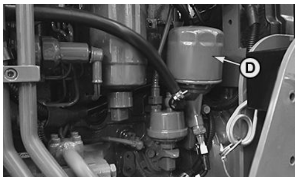
F5C motor - Oliefilter
