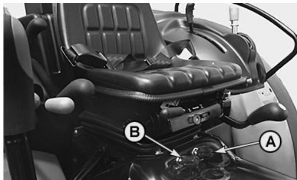
А—Копче за регулиране на скоростта на спускане
