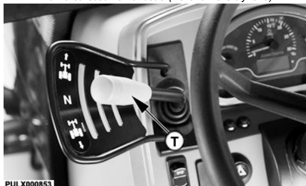
Рачка за возење наназад (електрично вклучена)
