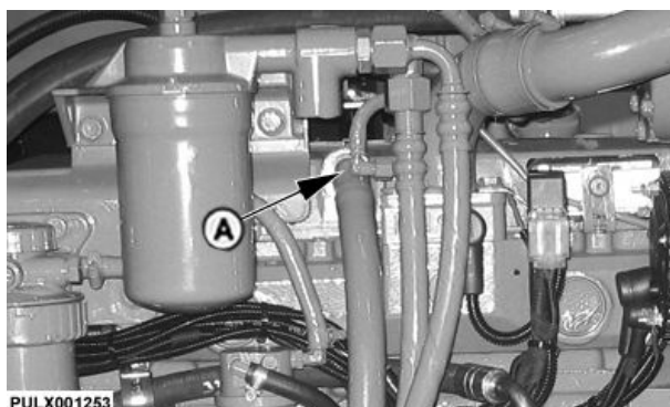
А—Цевка за вентилација на картерот
